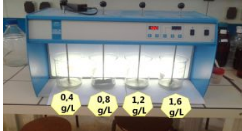
شكل 9. معالجة مياه الصرف الصحي باعتماد تقنية التخثر والتلبد
